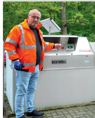
Barrierearme imvisio Müllschleuse von vorne.
